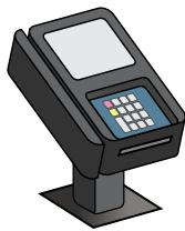
Un **TERMINAL DE PAIEMENT** est l'appareil utilisé pour accepter les paiements par carte client via insertion latérale, verticale ou horizontale, via lecture par contact ou via la saisie manuelle du numéro de carte. Terminal de paiement électronique (ou POS), lecteur de carte de crédit, terminal PDQ ou terminal EMV/à puce sont également des noms employés pour décrire ces appareils.
