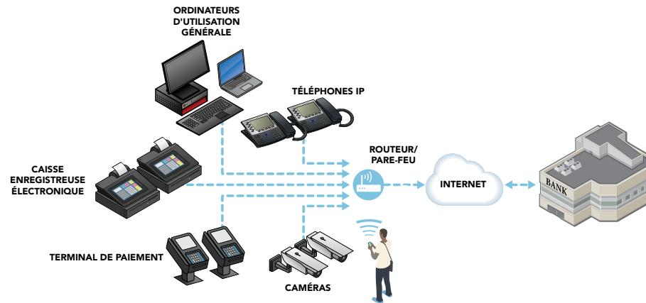
Système de paiement complexe pour les achats en magasin, avec connexion Wi-Fi, caméras, téléphones Internet et autres systèmes associés
