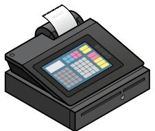
Une **CAISSE ENREGISTREUSE ÉLECTRONIQUE** (ou tiroir-caisse) enregistre et calcule les transactions et peut imprimer des tickets de caisse, mais elle n'accepte pas les paiements par carte client.
