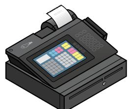
Un **TERMINAL DE PAIEMENT INTÉGRÉ** est un terminal de paiement combiné à une caisse enregistreuse électronique, ce qui signifie que cet appareil accepte les paiements par carte, enregistre et calcule les transactions et imprime des tickets de caisse.
